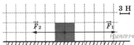
**30.** Две силы, лежащие на одной прямой, действуют на тело массой  $m$ . На каком рисунке изображена ситуация с расположением сил, дающих наибольшее ускорение?
