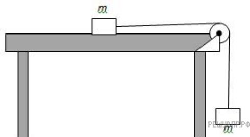
12. Неподвижный груз, расположенный на столе с бортиком, закреплен к столу с помощью пружины и тянется с помощью нити как показано на рисунке. Нарисуйте все силы, действующие на брус. Трением пренебречь.
