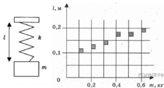
Согласно этим измерениям, коэффициент упругости пружины приблизительно равен
