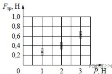
Согласно этим измерениям, приблизительно коэффициент трения скольжения тела по поверхности, на которой проводился эксперимент, равен
