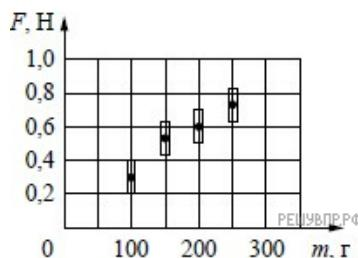
Согласно этим измерениям, приблизительно коэффициент трения скольжения тела по поверхности, на которой проводился эксперимент, равен
