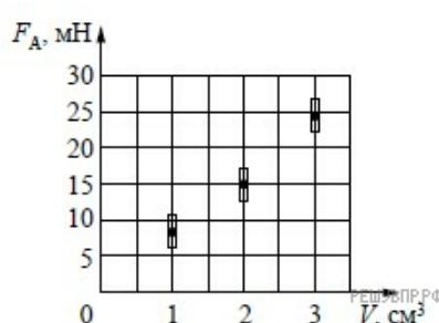
Согласно этим измерениям, приблизительно плотность жидкости, в которую опускали тело равна
