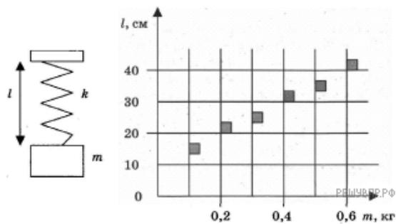
Согласно этим измерениям, коэффициент упругости пружины приблизительно равен
