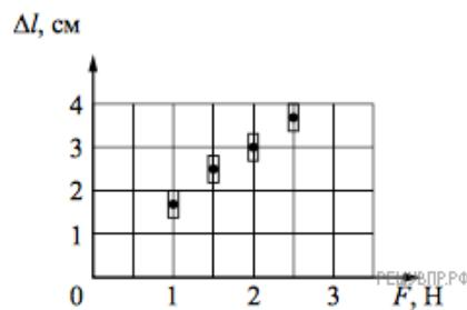
Согласно этим измерениям, приблизительно коэффициент упругости пружины равен
