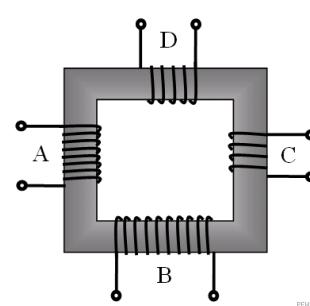
**9.** В трансформаторе, изображённом на рисунке, на вход А подают переменное напряжение. На обмотках В, С и D возникает ЭДС индукции. Количество витков равно изображённому на рисунке. Расположите обмотки В, С и D в порядке уменьшения ЭДС индукции. Запишите в ответе соответствующую последовательность цифр.
