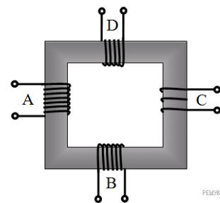
**2.** В трансформаторе, изображённом на рисунке, на вход А подают переменное напряжение. На обмотках В, С и D возникает ЭДС индукции. Количество витков равно изображённому на рисунке. Расположите обмотки В, С и D в порядке уменьшения ЭДС индукции. Запишите в ответе соответствующую последовательность цифр.
