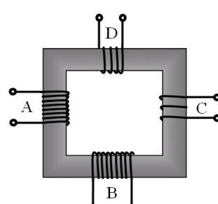
**5.** В трансформаторе, изображённом на рисунке, на вход А подают переменное напряжение. На обмотках В, С и D возникает ЭДС индукции. Количество витков равно изображённому на рисунке. Расположите обмотки В, С и D в порядке уменьшения ЭДС индукции. Запишите в ответе соответствующую последовательность цифр.
