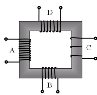
**11.** В трансформаторе, изображённом на рисунке, на вход А подают переменное напряжение. На обмотках В, С и D возникает ЭДС индукции. Количество витков равно изображённому на рисунке. Расположите обмотки В, С и D в порядке уменьшения ЭДС индукции. Запишите в ответе соответствующую последовательность цифр.
