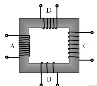
**13.** В трансформаторе, изображённом на рисунке, на вход А подают переменное напряжение. На обмотках В, С и D возникает ЭДС индукции. Количество витков равно изображённому на рисунке. Расположите обмотки В, С и D в порядке уменьшения ЭДС индукции. Запишите в ответе соответствующую последовательность цифр.
