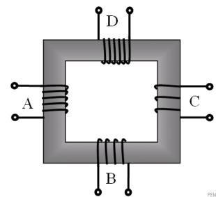
**8.** В трансформаторе, изображённом на рисунке, на вход А подают переменное напряжение. На обмотках В, С и D возникает ЭДС индукции. Количество витков равно изображённому на рисунке. Расположите обмотки В, С и D в порядке возрастания ЭДС индукции. Запишите в ответе соответствующую последовательность цифр.
