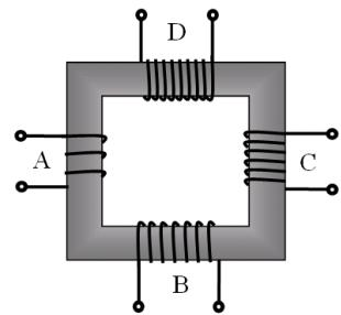
**7.** В трансформаторе, изображённом на рисунке, на вход А подают переменное напряжение. На обмотках В, С и D возникает ЭДС индукции. Количество витков равно изображённому на рисунке. Расположите обмотки В, С и D в порядке уменьшения ЭДС индукции. Запишите в ответе соответствующую последовательность цифр.
