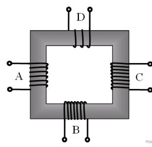
**10.** В трансформаторе, изображённом на рисунке, на вход А подают переменное напряжение. На обмотках В, С и D возникает ЭДС индукции. Количество витков равно изображённому на рисунке. Расположите обмотки В, С и D в порядке возрастания ЭДС индукции. Запишите в ответе соответствующую последовательность цифр.
