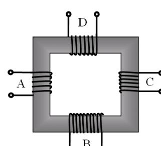
**6.** В трансформаторе, изображённом на рисунке, на вход А подают переменное напряжение. На обмотках В, С и D возникает ЭДС индукции. Количество витков равно изображённому на рисунке. Расположите обмотки В, С и D в порядке возрастания ЭДС индукции. Запишите в ответе соответствующую последовательность цифр.
