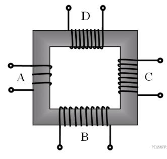
**15.** В трансформаторе, изображённом на рисунке, на вход А подают переменное напряжение. На обмотках В, С и D возникает ЭДС индукции. Количество витков равно изображённому на рисунке. Расположите обмотки В, С и D в порядке уменьшения ЭДС индукции. Запишите в ответе соответствующую последовательность цифр.
