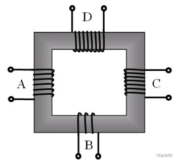
**12.** В трансформаторе, изображённом на рисунке, на вход А подают переменное напряжение. На обмотках В, С и D возникает ЭДС индукции. Количество витков равно изображённому на рисунке. Расположите обмотки В, С и D в порядке возрастания ЭДС индукции. Запишите в ответе соответствующую последовательность цифр.
