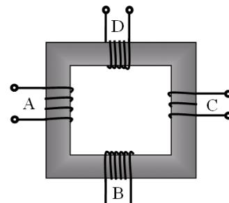
**4.** В трансформаторе, изображённом на рисунке, на вход А подают переменное напряжение. На обмотках В, С и D возникает ЭДС индукции. Количество витков равно изображённому на рисунке. Расположите обмотки В, С и D в порядке увеличения ЭДС индукции. Запишите в ответе соответствующую последовательность цифр.
