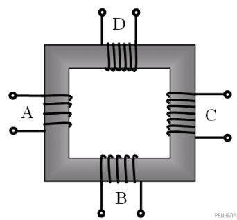
**14.** В трансформаторе, изображённом на рисунке, на вход А подают переменное напряжение. На обмотках В, С и D возникает ЭДС индукции. Количество витков равно изображённому на рисунке. Расположите обмотки В, С и D в порядке возрастания ЭДС индукции. Запишите в ответе соответствующую последовательность цифр.
